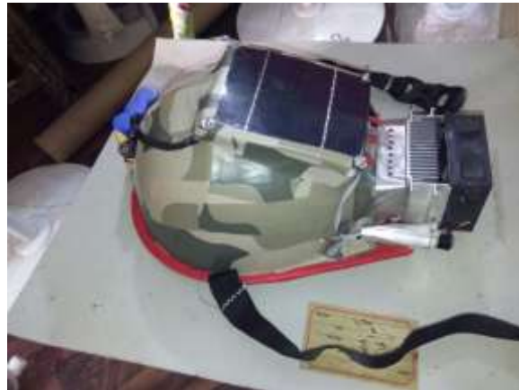
Fig. 2.2 Actual photo of solar power helmet
