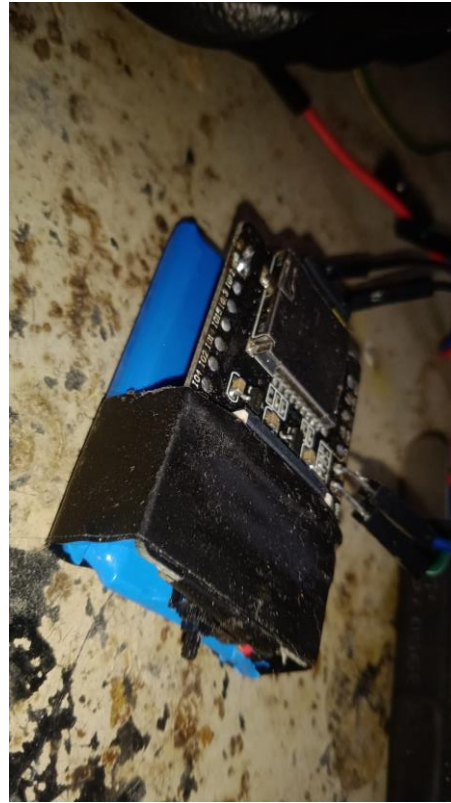
Fig -8: Pendant (ESP32, Battery)
